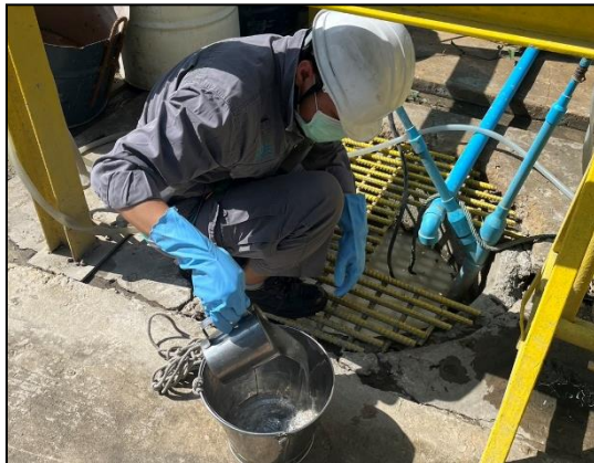
รูปที่ 4.7 การเก็บตัวอย่างคุณภาพน้ำทิ้ง บริเวณบ่อพักน้ำสุดท้ายก่อนระบาย ออกจากโครงการ
